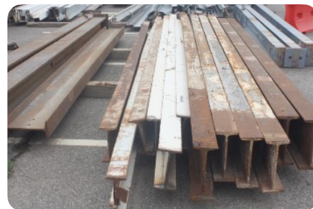
Stockage des poutrelles récupérés par lots et sur des supports en bois © Opalis (Premys Ferrari)
