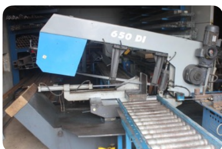
Installation pour le sciage de poutrelles © Opalis (Wolter Bouwmaterialen)
