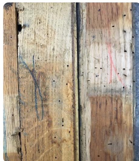
*Il convient de s'assurer de l'absence de larves d'insectes xylophages qui pourraient se propager à d'autres éléments en bois dans le bâtiment. Une inspection visuelle des planches est préconisée au moment de la mise en œuvre. Pour plus de sécurité, il est également possible d'exiger des lames séchées artificiellement (kiln drying process), voire de prévoir un traitement de préservation insecticide ou un traitement thermique.*
