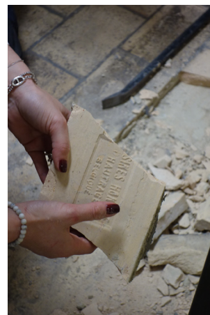
Een voorafgaande inventaris en ontmantelingstests kunnen het potentieel van de voor recuperatie beoogde loten bevestigen.
